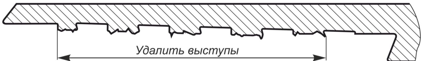
б) – Поверхность резьбового соединения раструбного конца трубы
